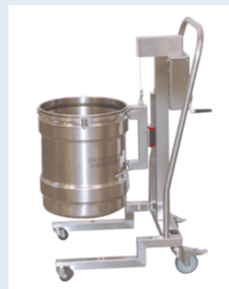
Pinza manual Pinza manual para la manipulación de barriles.
